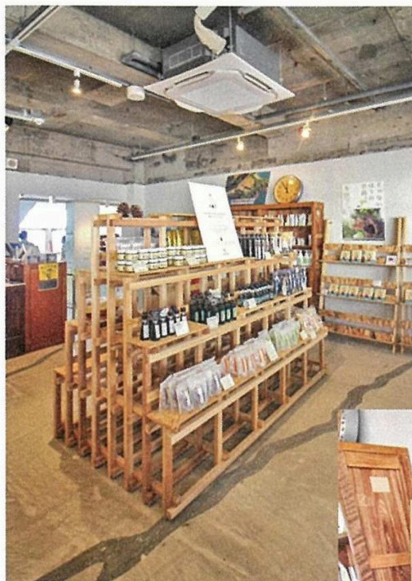
インニッサン(30×40mm)をジャングルジムのように組んでOSBの棚板を載せた什器
