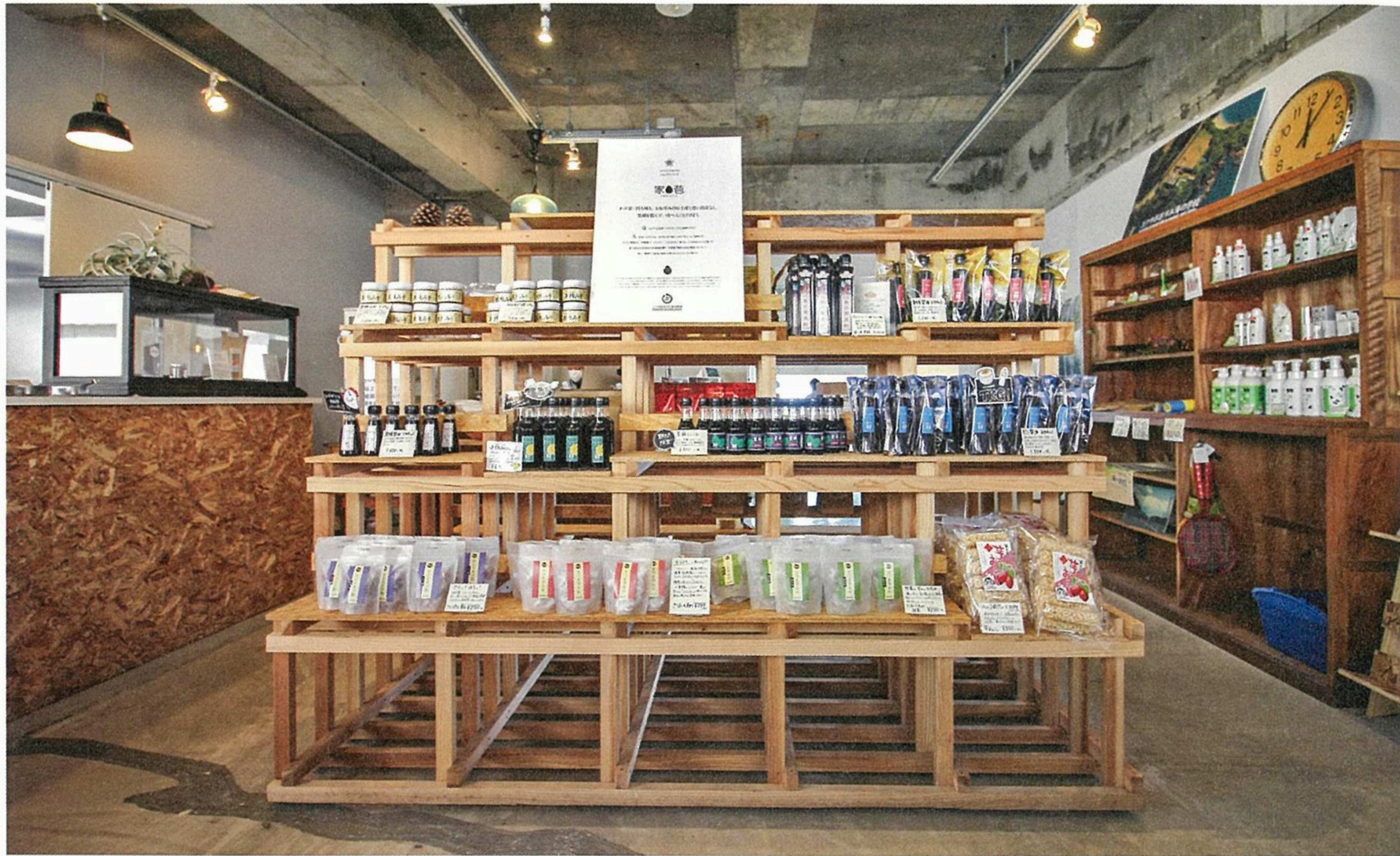
インニッサン(30×40mm)をジャングルジムのように組んでOSBの棚板を載せた什器
